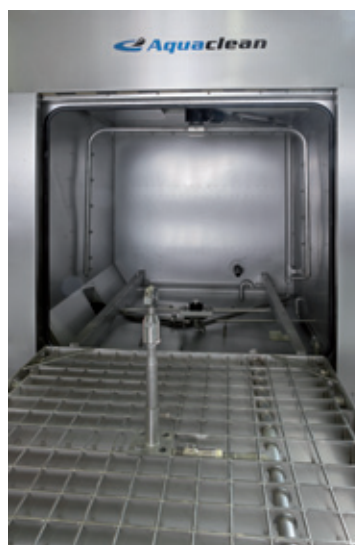
Limpieza de colectores Para limpieza interna de componentes, con acoplamiento rápido
